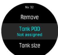
3. Из списка устройств Tank POD выберите то, серийный номер которого соответствует указанному на Suunto Tank POD.
