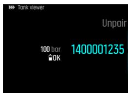
4. Убедитесь, что Suunto Tank POD активирован: на экране должно отображаться давление в баллоне, а зеленый светодиод POD должен мигать.
