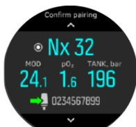
**ПРИМЕЧАНИЕ:** Уровень заряда батареи отображается только в том случае, если заряд батареи низкий. Показатель, отображаемый при сопряжении с устройством Suunto Tank POD, является приблизительным.
