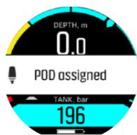
В главном представлении окна погружения отображается давление только в одном баллоне в соответствии с активной дыхательной смесью. При изменении дыхательной смеси отображаемое давление в баллоне изменяется соответственно.
